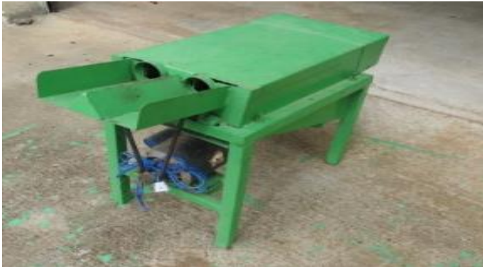
Motor operated Mini Maize Sheller ಮೋಟಾರ್ ಚಾಲಿತ ಚಿಕ್ಕ ಮೆಕ್ಕೆಜೋಳ ಸುಲಿಯುವ ಯಂತ್ರ
